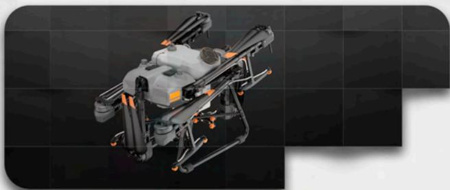
Sua estrutura oferece resistência IP67, que protege as partes internas do drone contra água, pesticidas, fertilizantes, poeira e corrosão.
