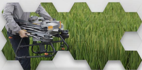
Sua estrutura oferece resistência IP67, que protege as partes internas do drone contra água, pesticidas, fertilizantes, poeira e corrosão.
